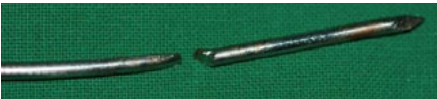
Abb. 5: Abgebohrter Zieldraht mit thermischer Verfärbung
